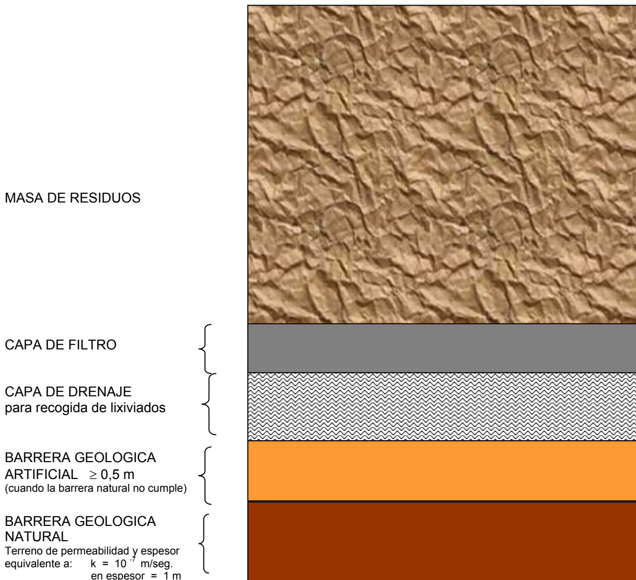
Figura 5.1.- Vertederos de residuos inertes. (Solución de Referencia)
