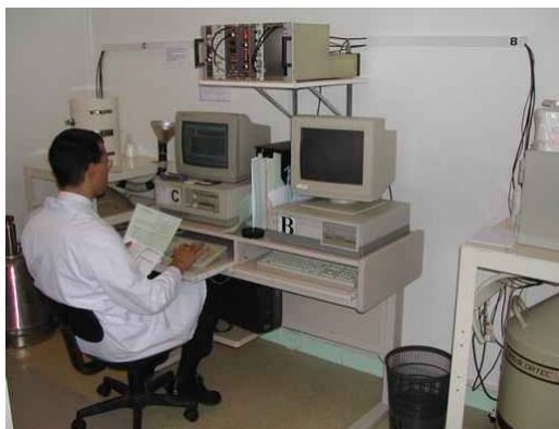
Sala de contaje por espectrometría gamma (laboratorio CRIIRAD)
